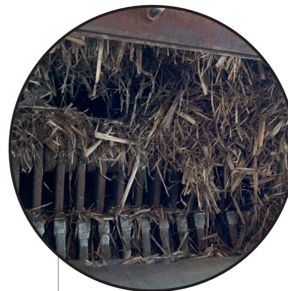
Trituração de palha em triturador de martelos
