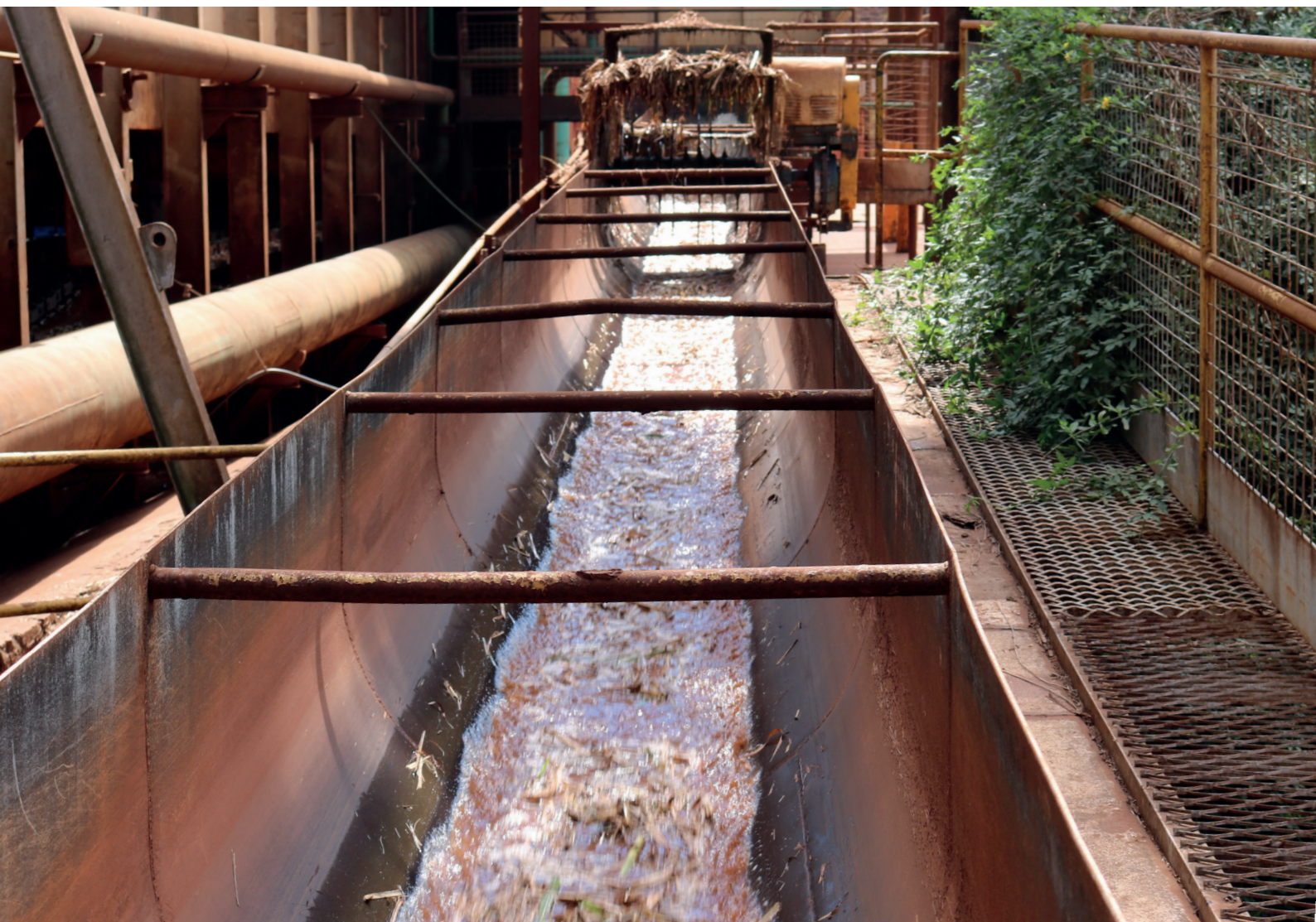
Transporte e lavagem de palha em calha com água
