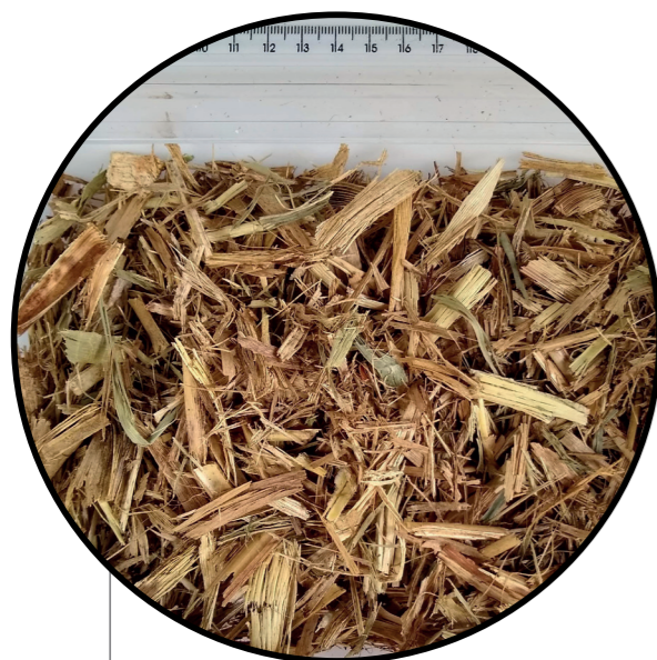
Aspecto da palha triturada em terno independente de moenda
