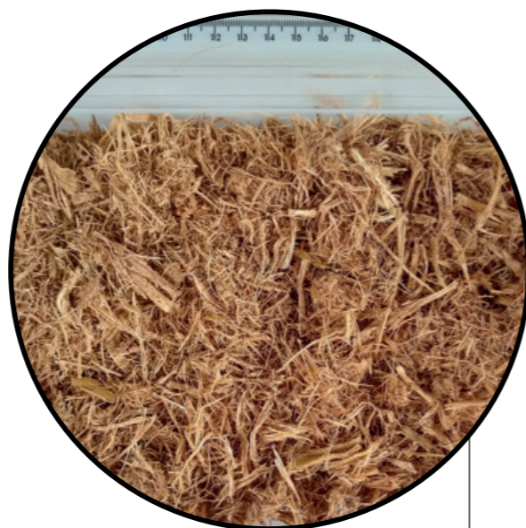
Aspecto da mistura bagaço-palha produzida através da alimentação de palha no último terno de extração em moendas.
