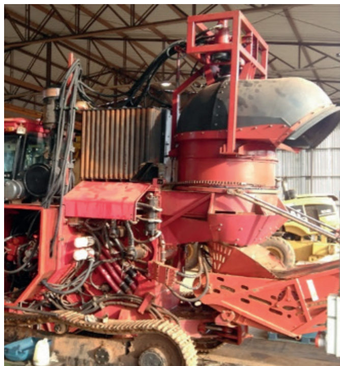
Montagem do triturador de palha/CTC em colhedora comercial de usina parceira, e operando no campo
