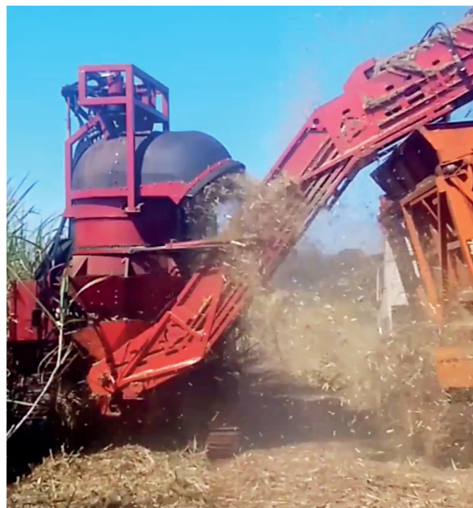
Montagem do triturador de palha/CTC em colhedora comercial de usina parceira, e operando no campo
