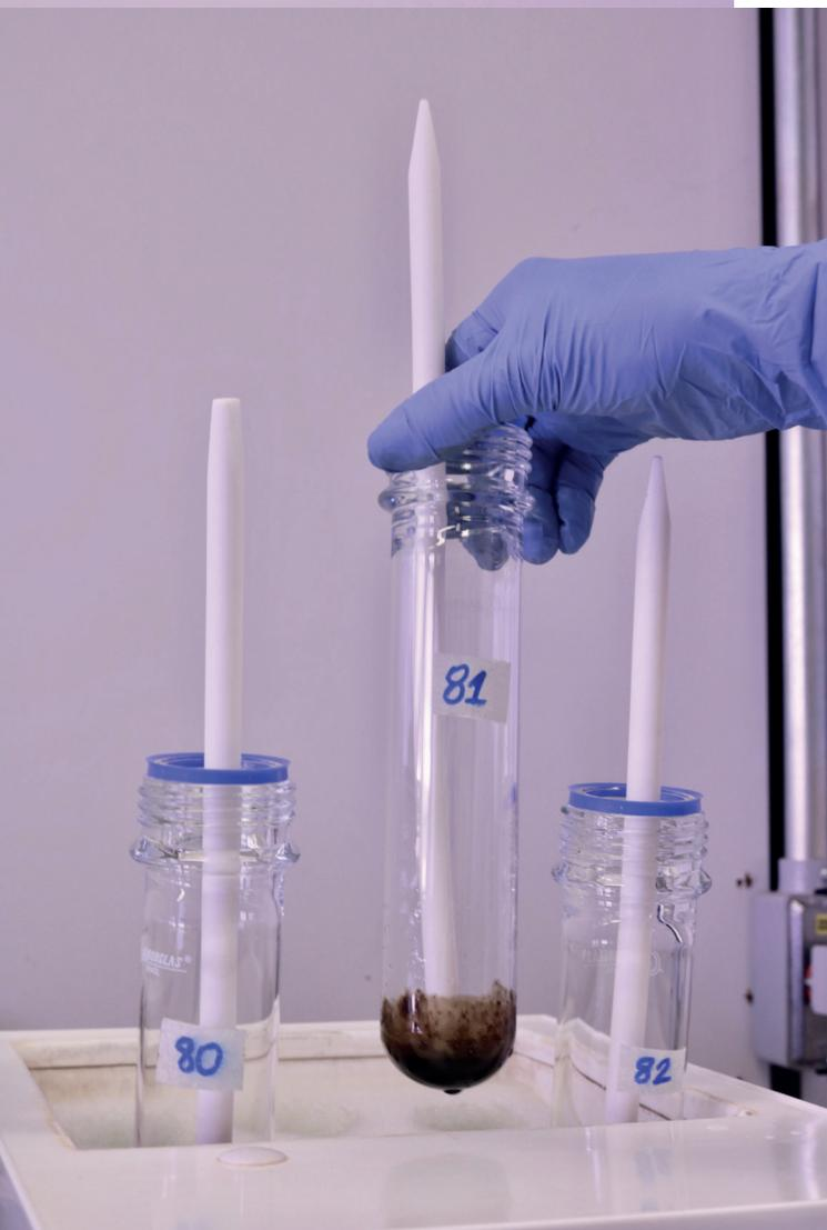
**9.5.2.7** Com o auxílio de um bastão agitar a suspensão a cada 5 - 10 minutos sem remover o tubo do banho. Solubilizar a amostra friccionando o material com o bastão (Figura 7).
