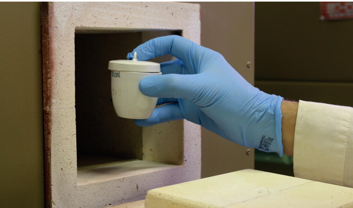
**Figura 1.** Cadinho de porcelana previamente tarado com amostra a ser calcinada para determinação de cinzas totais.
